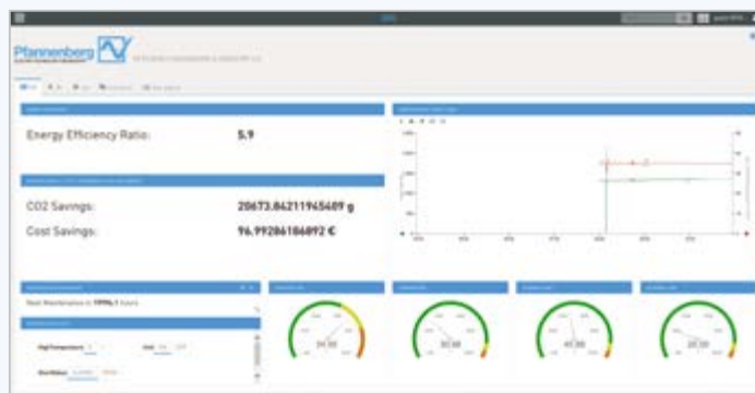
Приборная панель облачного решения показывает пользователю различные статусы, анализ диагностики и аварийные состояния в режиме реального времени.
